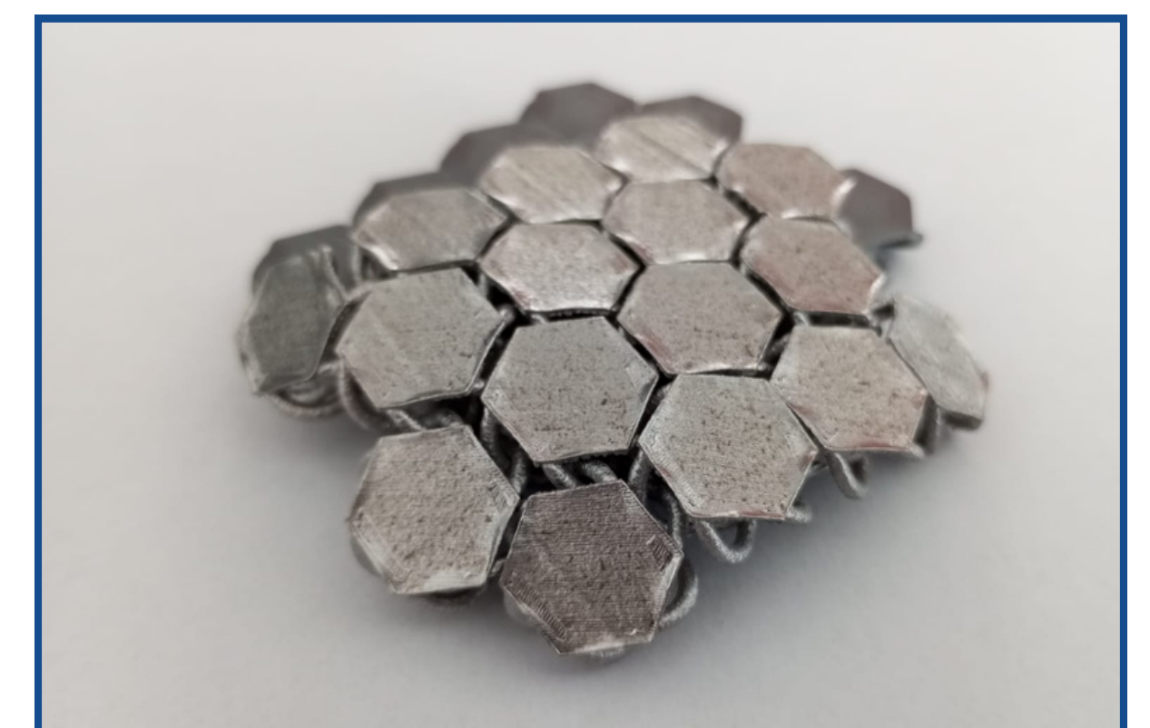
Rys. 6. Widok metalowego materiału wytworzonego przyrostowo
